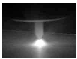
スタート時の溶落ちを防ぎ、 終端処理もやさしくなります。
